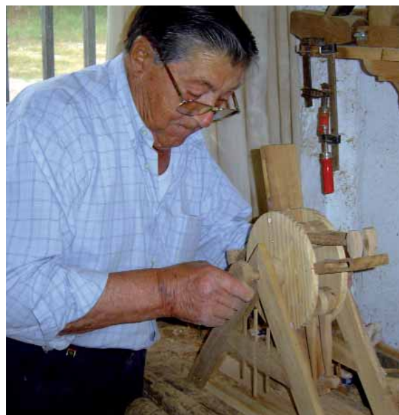
Batzoles de mà : el ebanista Pedro Buigues Oller monta en su taller artesanal una matraca de mano que reconstruye el mismo sistema de percusión que las batzoles de campanario. (Teulada, 2006). Jaume Buigues i Vila.
